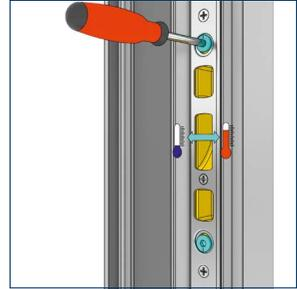
Danach kann die Schließtasche mit einem 4er Inbus durch Drehen der Stellschrauben nach links und rechts bewegt werden. Anschließend die Kreuzschlitzschraube wieder anziehen.
