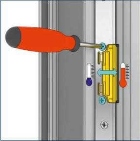
Das Fallengegenstück kann nach Lösen der Kreuzschlitzschrauben im 1 mm Raster verstellt werden. Anschließend die Kreuzschlitzschrauben wieder anziehen.
